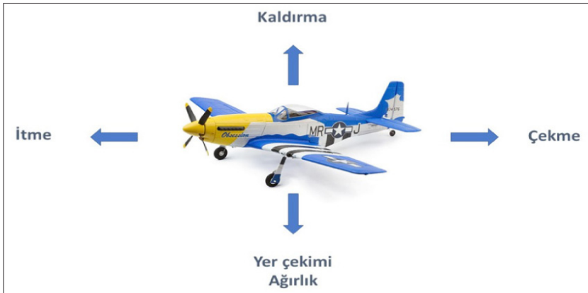
Şekil 1. Uçaklara Etki Eden Dört Farklı Kuvvet. ( https://t24.com.tr )
